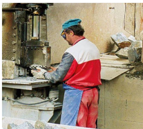
Obrázek 30 Lom na granodiorit nedaleko obce Ctětín – ukázka lámání „žuly“. Zdroj: DOUCEK – SMUTEK (2013)
