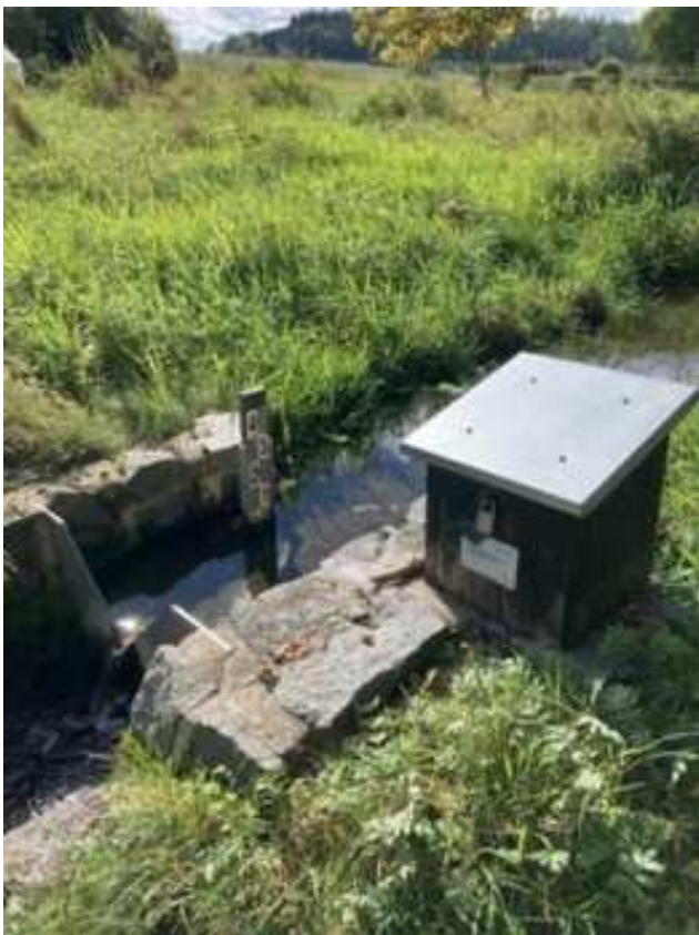
Obrázek 10: Vodní zdroj PR-1 (Blatnice), vodočet spolu s měrným profilem ve tvaru V
