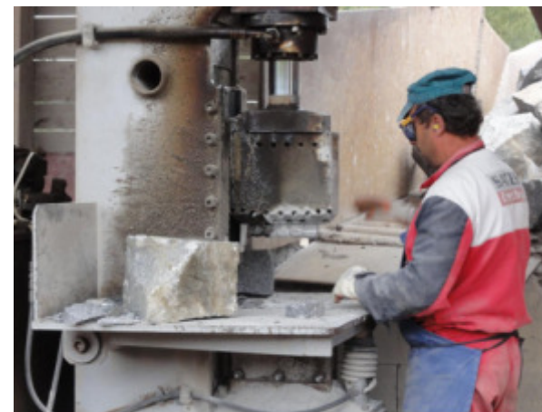
20. Štípání kostek z granodioritu ve Ctětinku
